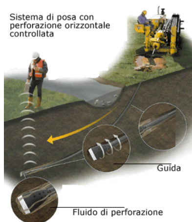
Figura 2 – Fasi di lavorazione di un no-dig
