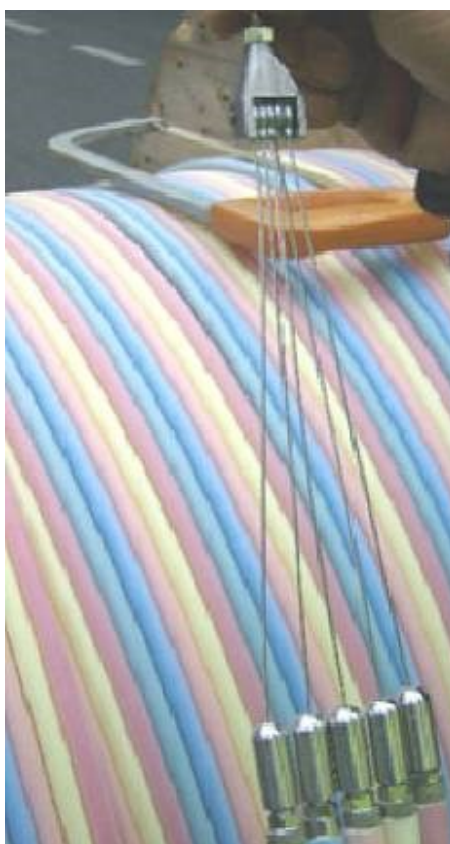
Figura 7 - Esempio di dispositivo di tiro dei minitubi
